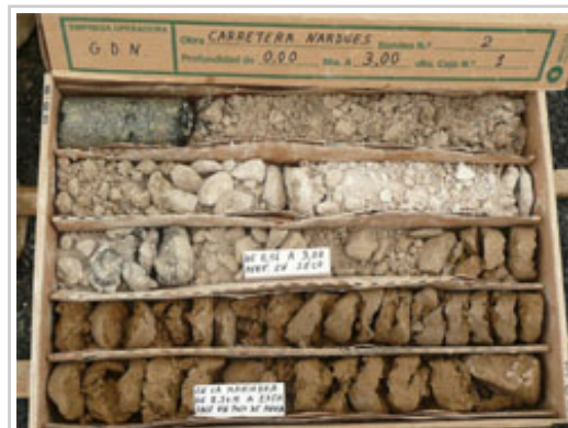
Muestras de material obtenidas de los sondeos previos al inicio de las obras.
