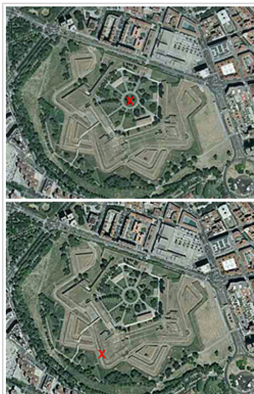
Ejemplo de cómo ha variado el punto que señalan las coordenadas x=610538 e y=474107 al migrar del sistema de referencia ED50 (imagen de arriba) al ETRS89 (imagen de abajo).
