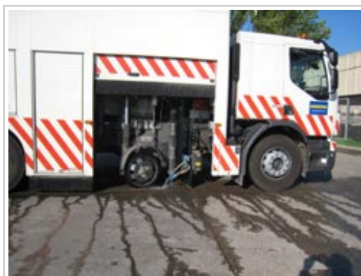
Imagen del sistema para la comprobación de la adherencia del firme, instalado en un vehículo pesado.
