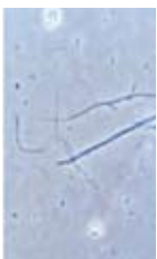
Figura A1.10 Fibras de amianto enaire recogidas en filtro para recuento (Microscopio óptico 500X)
