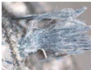
Figura A1.4 Material con amianto CROCIDOLITA (60 X)
