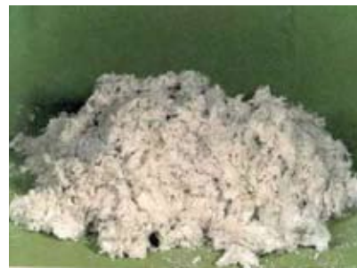
Figura A1.13 Aislante de interior de puertas cortafuegos. Relleno de cámaras de aire de paredes y techos
