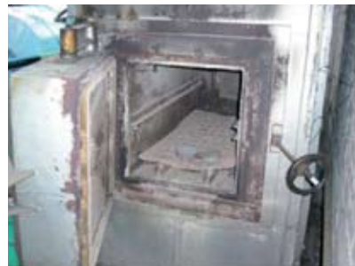
Figura A1.32 Junta textil en un horno
