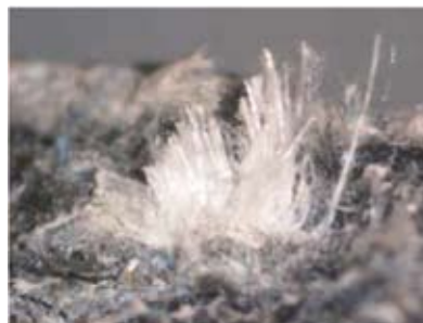
Figura A1.3 Material con amianto CRISOTILO (60 X)
