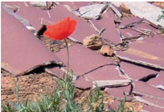
Figura A3.27b Residuos incontrolados de fibrocemento
