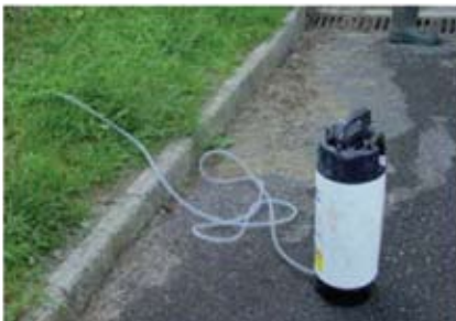
Figura A3.15 Bomba manual de presión y manguera para la humectación de conductos de fibrocemento en trabajos de mantenimiento
