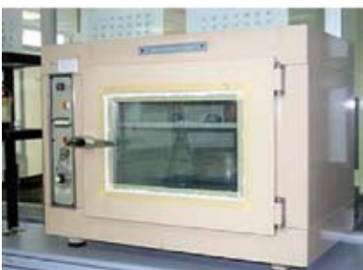
Figura A1.41 Junta aislante en la puerta de una estufa de secado
