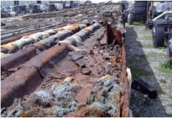
Figura A3.27a Residuos incontrolados de crocidolita retirados de vagones de ferrocarril
