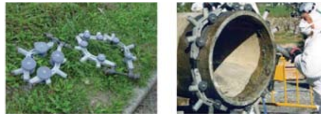
Figura A3.18a y b Herramienta manual de corte para conductos de fibrocemento y detalle de utilización
