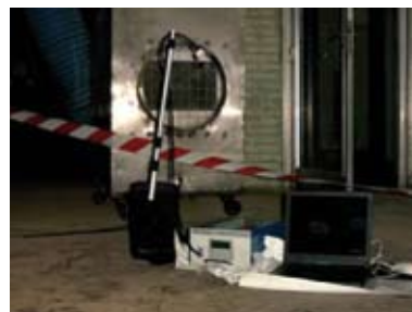
Figura A3.10 Mediciones de control del aire en el exterior de la burbuja
