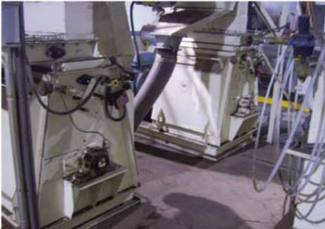
Figura 32. Molinos de martillos sin protección.
