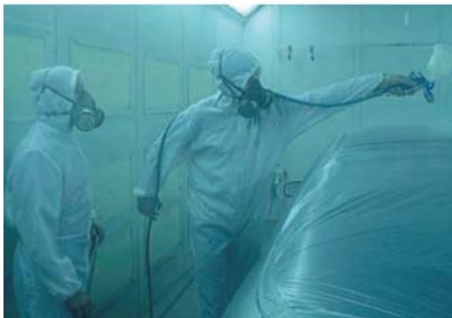
Figura 5. Uno de los procesos donde es normal la formación de nieblas es en pintura por proyección. Si esta pintura o sus disolventes son inflamables, se podría formar una ATEX.
