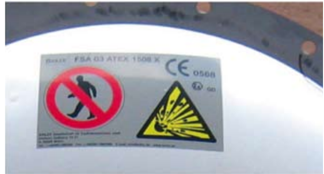
Figura 40. Marcado de sistema de protección
