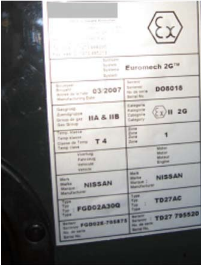
Figura 39. Marcado de equipos no eléctricos.
