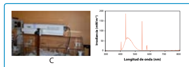
Imágenes de dispositivos de fototerapia junto con los espectros de salida medidos. (A) Waldmann UV 7001 UVB. (B) Waldmann UV 181 BL. (C) Dräger PhotoTherapy 4000.
