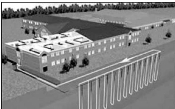
En el año 2010 se ejecutó la obra de implantación de un sistema de Geotermia en el recinto de la Clínica Ubarmin. A través de la empresa de Servicios Energéticos Grupo VISIONA BD Navarra se ejecutó la instalación para la generación de calor, frío y precalentamiento del ACS a través de la Geotermia.
