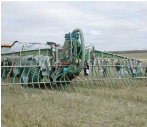
Imagen: Cuba de purines equipada con repartidor de tubos colgantes en praderas.
